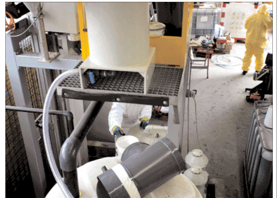
Réacteur utilisé pour le traitement des déchets de chrome, une autre spécialité de l'entreprise genevoise.
